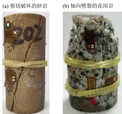
图2 单轴压缩破坏后岩石照片
